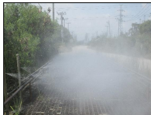
ภาพที่ 3.57 บ่อฉีดล้างล้อรถบรรทุกในช่วงถนนคอนกรีตของเส้นทางขนส่งแร่
